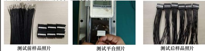
2) 端子对塑胶止推力测试图片
