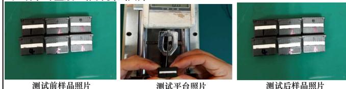
3) 端子对塑胶固定力 (不带TPA) 测试图片
