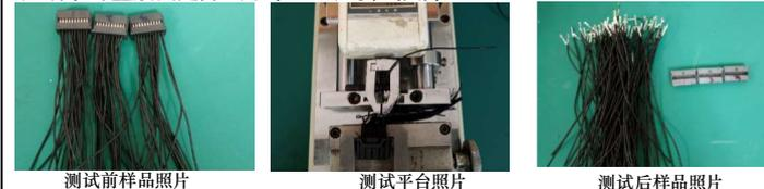
4) 端子对塑胶固定力 (带TPA) 测试图片
